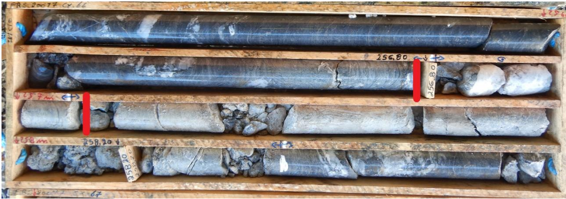
Fig. 45 – Caixa de sondagem da FRS20017, onde é possível observar as características descritas para o filão de São Jerónimo entre a metragem dos 256,80 m até aos 257,10 m (delimitadas a vermelho).
