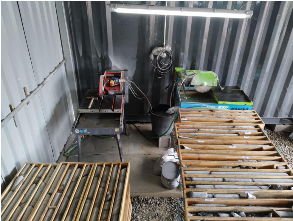
Fig. 36 – Serras elétricas associadas a disco diamantado de corte de carote onde foi realizada a amostragem. Na figura é ainda possível observar as caixas de sondagem com os intervalos a amostrar com o respetivo sample ticket .
