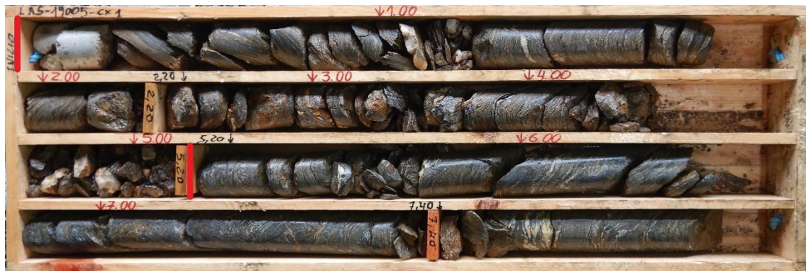
Fig. 29 – Caixa de sondagem da LAS19005, onde é possível observar as características descritas entre a metragem dos 0,00 m até aos 5,20 m (delimitadas a vermelho).
