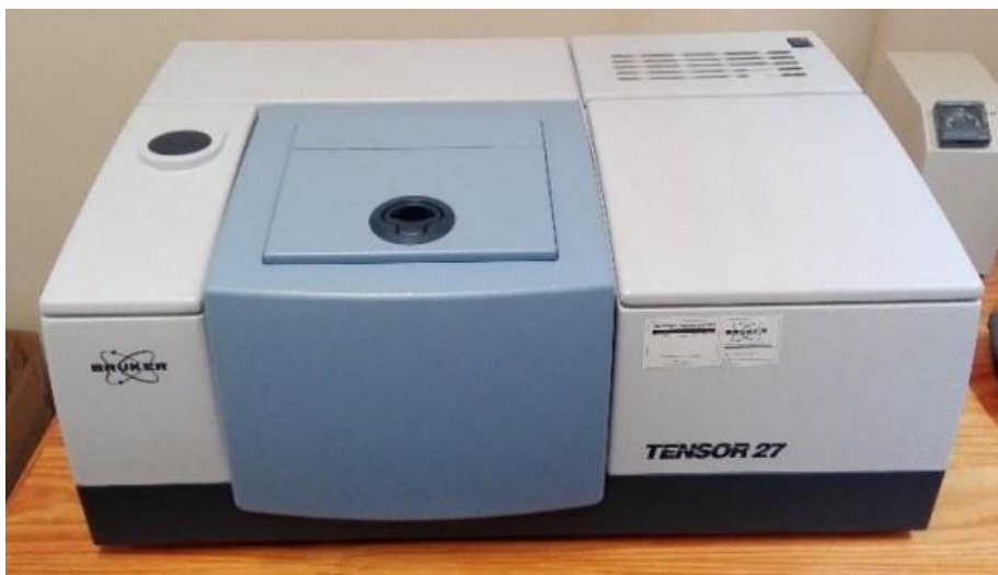
Fig. 16 – Equipamento de espectroscopia de infravermelhos Bruker Tensor 27 .
