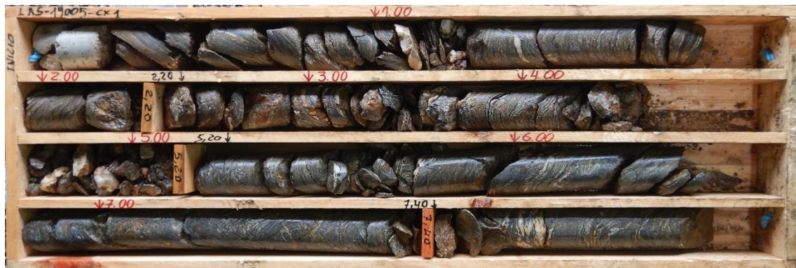
Fig. 27 – Figura representativa da sondagem LAS19005 onde consta a correta marcação da metragem, de metro a metro (representada pela numeração a vermelho).
