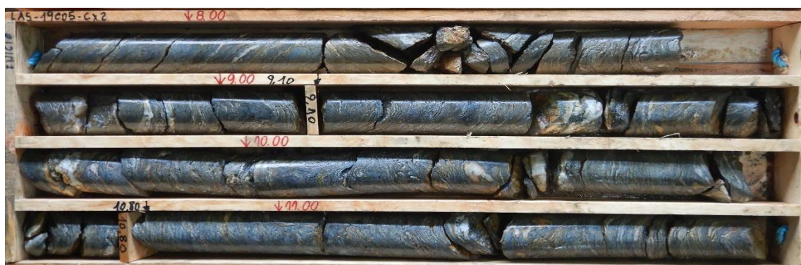
Fig. 30 – Caixa de sondagem da LAS19005, onde é possível observar as características descritas para o filito.
