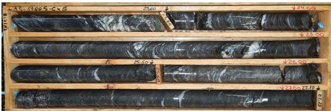
Fig. 31 – Caixa de sondagem da LAS19005, representativa de todas as características observadas e descritas para o quartzofilito.
