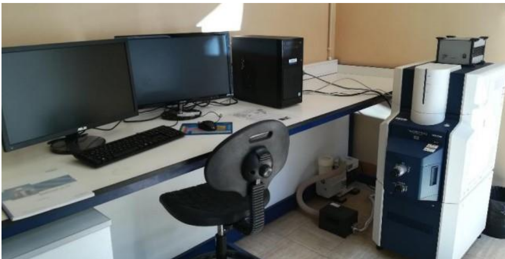
Fig. 14 – Microscópio eletrónico de varrimento Hitachi FlexSEM 100 .
