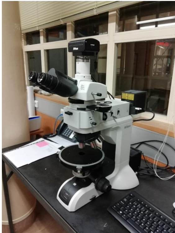
Fig. 12 – Microscópio petrográfico de luz polarizada transmitida e refletida Nikon Eclipse Lv100N Pol Tipo R .
