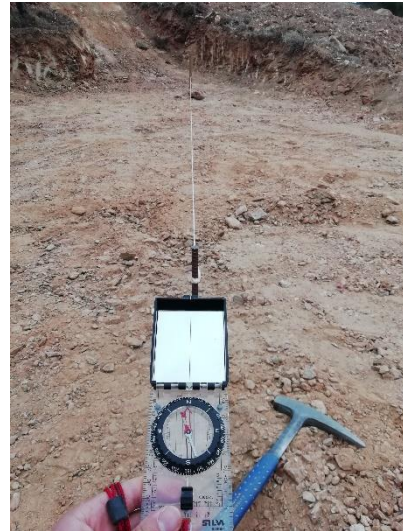
Fig. 21 – Realização de alinhamento S-N para a correta colocação da sonda nas plataformas de sondagem. Este alinhamento foi executado recorrendo à bússola e à coordenada definida para a colocação da boca do furo de sondagem.
