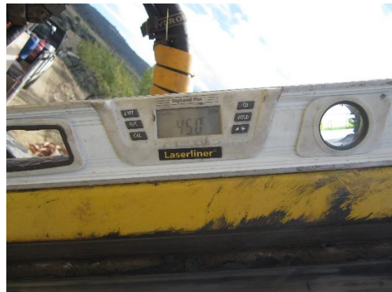
Fig. 23 – Correta inclinação de perfuração (-45°) para o início da sondagem.
