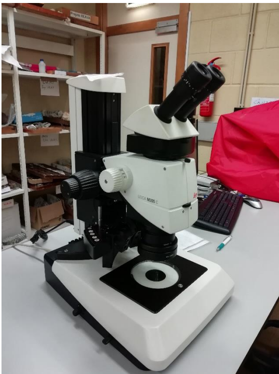
Fig. 13 – Lupa binocular de luz polarizada transmitida e refletida Leica M205 C .
