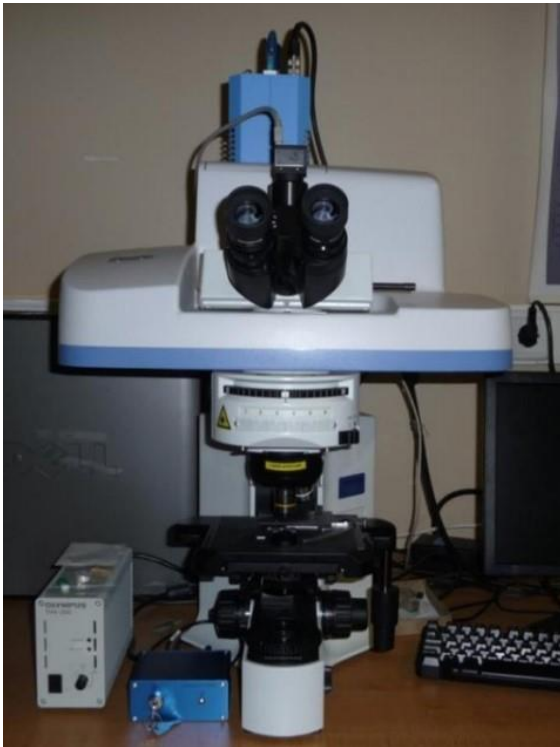
Fig. 17 – Equipamento de espectroscopia Raman LabRAM HORIBA Jobin Yvon Spex .
