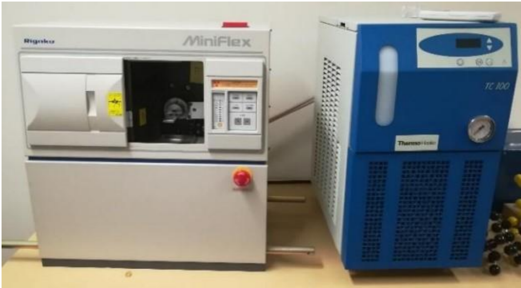
Fig. 15 – Equipamento de difração de raios-X Rigaku Miniflex .
