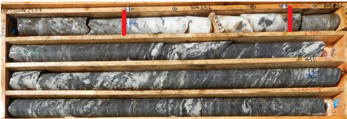
Fig. 46 – Caixa de sondagem da FRS20014, onde é possível observar as características descritas para o rock type VEIN entre a metragem dos 304,40 m até aos 304,90 m (delimitadas a vermelho).
