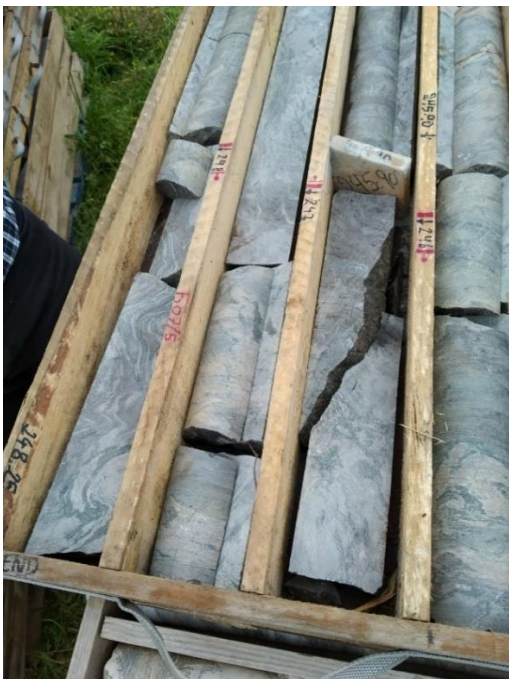
Fig. 37 – Amostragem de meia carote (enviada para o laboratório) e armazenamento da outra metade da carote na caixa de sondagem para posterior consulta e estudo, caso necessário. Observa-se também na caixa de sondagem a simbologia utilizada na amostragem.
