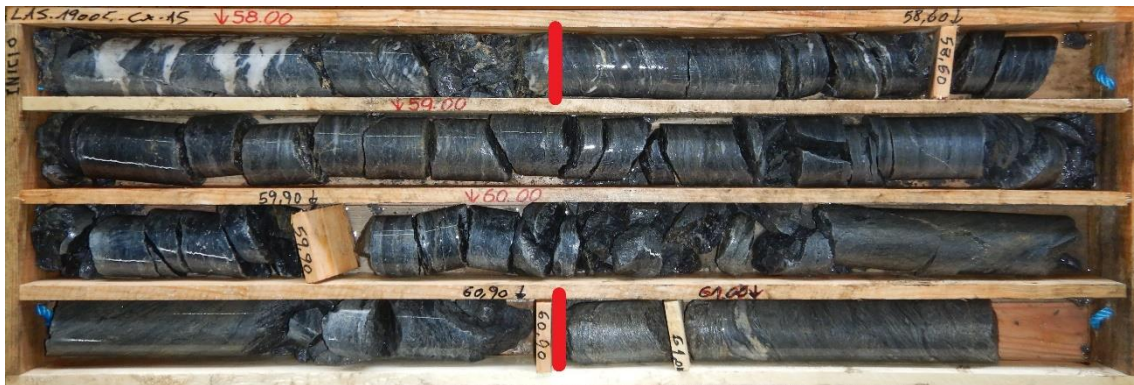
Fig. 34 – Caixa de sondagem da LAS19005, onde é possível observar as características descritas para o MMU entre a metragem dos 58,30 m até aos 60,90 m (delimitadas a vermelho).
