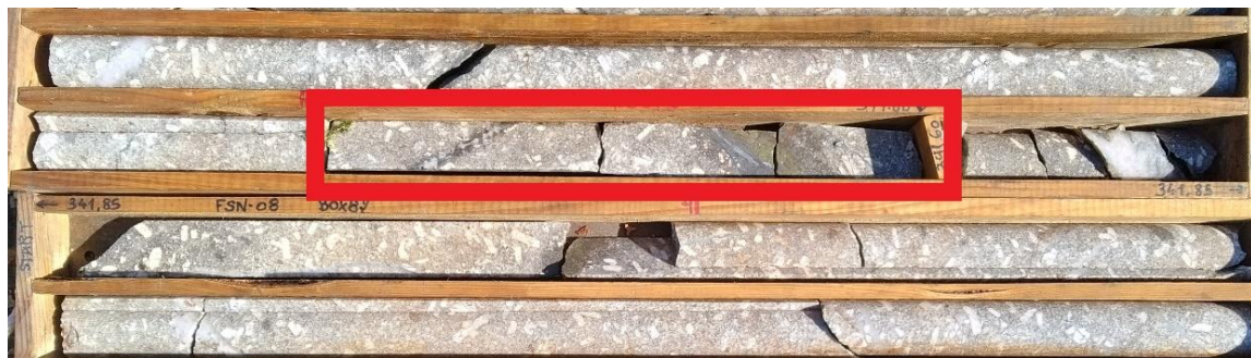
Fig. 49 – Caixas de sondagem da FSN08, onde é possível observar o filão de São Jerónimo com litologia encaixante de granito moscovítico (delimitado a vermelho).
