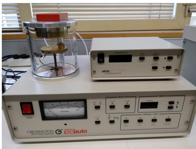
Figura 3.17 - Imagem do equipamento de pulverização catódica ( sputtering ), Cressington (modelo 108 auto).
