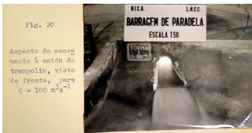
Fig. 122. Maqueta escala 1.50 da barragem de Paradela, Relatório do ensaio hidráulico da barragem de Paradela, parte II, Divisão de hidráulica LNEC, Lisboa, Abril de 1958.
