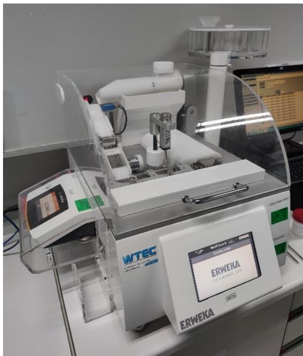
Figura 9: Aparelho Multicheck para medição de diversos parâmetros, como Uniformidade de massa, espessura, comprimento/diâmetro e dureza.
