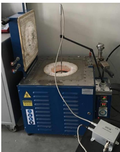
Figura 3.11. Forno com a sonda imersa no banho de alumínio, em operação.
