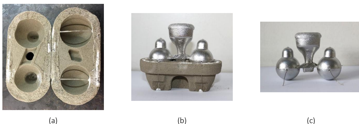
Figura 3.5. Fotografia do (a) cartucho AccuVo®-Cup aberto, (b) cartucho após vazamento e abertura da moldação superior e da (c) amostra obtida.
