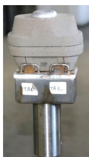
Figura 3.14. Cartucho de análise térmica inserido no suporte, representado no esquema da Figura 3.13.
