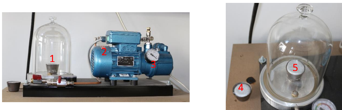
Figura 3.8. Equipamento RPT: 1- câmara de vácuo, 2- bomba de vácuo, 3- barómetro, 4- amostra solidificada à pressão atmosférica e 5- amostra solidificada em vácuo.
