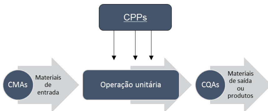
Figura 7- Ilustração da relação entre os materiais de entrada (CMAs e CPPs) e materiais de saída (CQAs) de uma operação unitária no processo de fabrico. Adaptado de (63).
