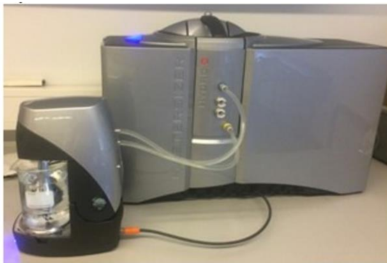
Figura 24 - Difratômetro laser Mastersizer 3000, com unidade de dispersão de amostras em meio líquido com volume flexível Hydro EV.
