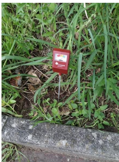
Figura 36 - Aplicação Survey123 (a) e recolha de dados do solo com um medidor pH (b).
