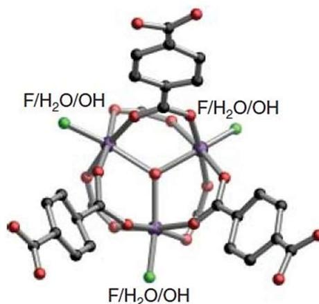
Figura 2.2: Representação estrutural de uma unidade de construção secundária (SBU), do MIL-101(Cr). Adaptado da literatura<sup>21</sup>
