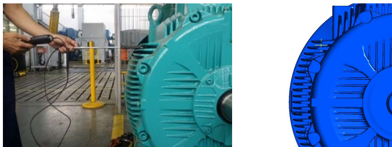
Figura 101 – Comparação entre ponto de medição de velocidade experimental e simulação
