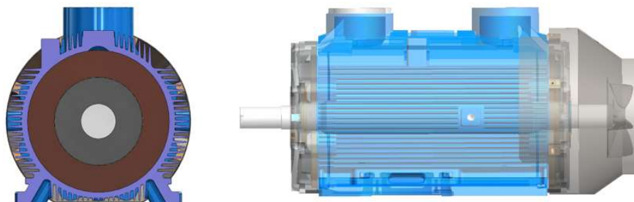
Figura 32 – Seção reta da montagem do motor à esquerda e com partes internas e montagem do motor após a remoção das partes internas à direita Fonte: Adaptado de arquivos de projetos da WEG.
