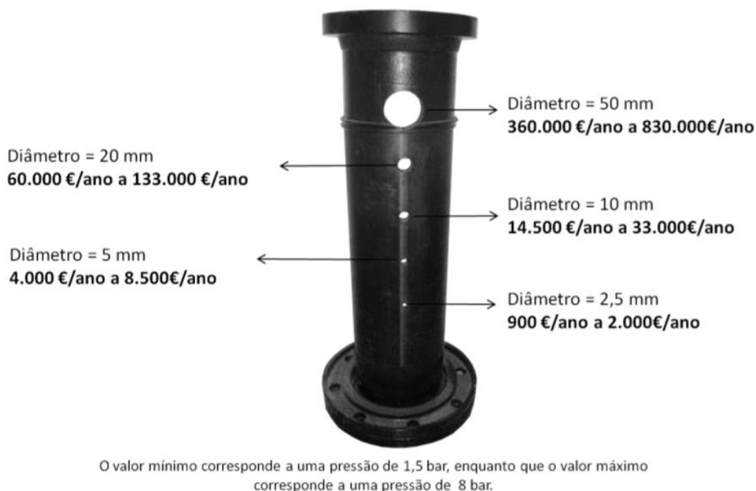
Figura 20: Relação entre pressão para orifícios de diferentes tamanhos e receita anual perdida em perdas de água (Martins, 2016).
