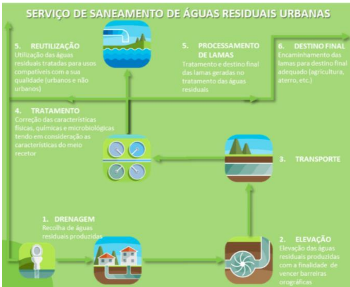
Figura 3: Componentes de um sistema de saneamento de águas residuais (ERSAR, 2019a).
