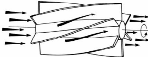
Figura 12: Esquema funcionamento de turbina helicoidal (Malheiro, 2011).
