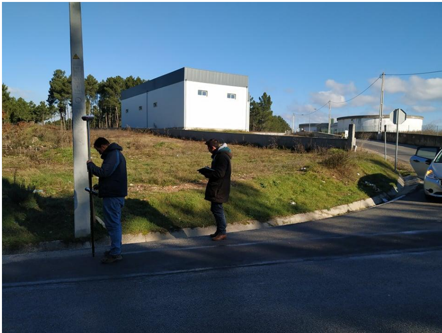
Figura 34: Realização de levantamento de campo com o Gps Stonex
