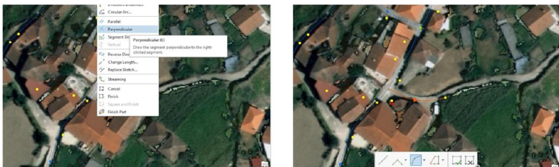
Figura 42: Desenho do ramal do Ponto de Consumo que se encontra afastado da rede abastecimento de água
