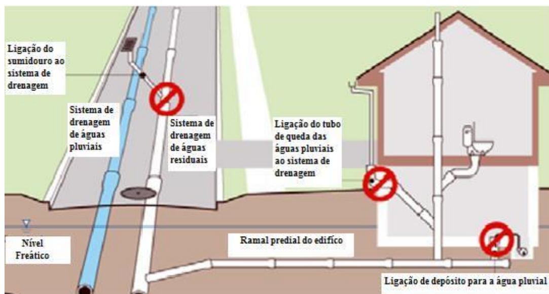
Figura 2.5. Exemplo de ligações indevidas à rede de drenagem de águas residuais. Retirado de (Mortinho, 2011)
