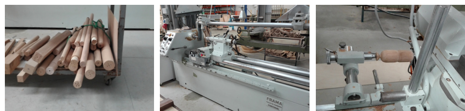
Fig. 20 - Torno mecânico, para tornear peças cilíndricas
