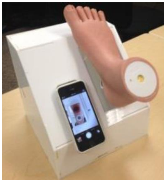
Figura 4.9 - Sistema de captura de imagem de úlceras de pé diabético tipo "box" (L. Wang et al., 2017).
