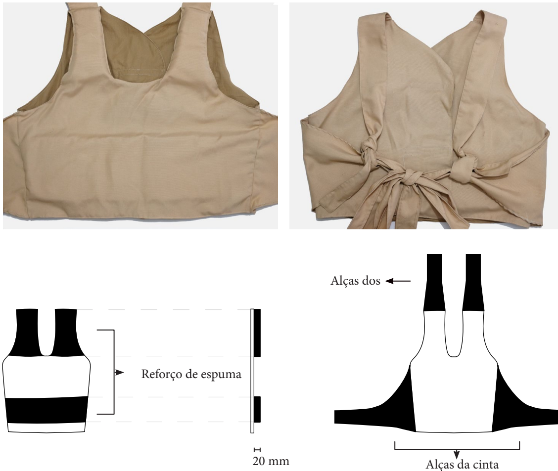
Figura 4.21. Desenho vetorial do colete com representação das zonas de reforço com espuma e das alças
