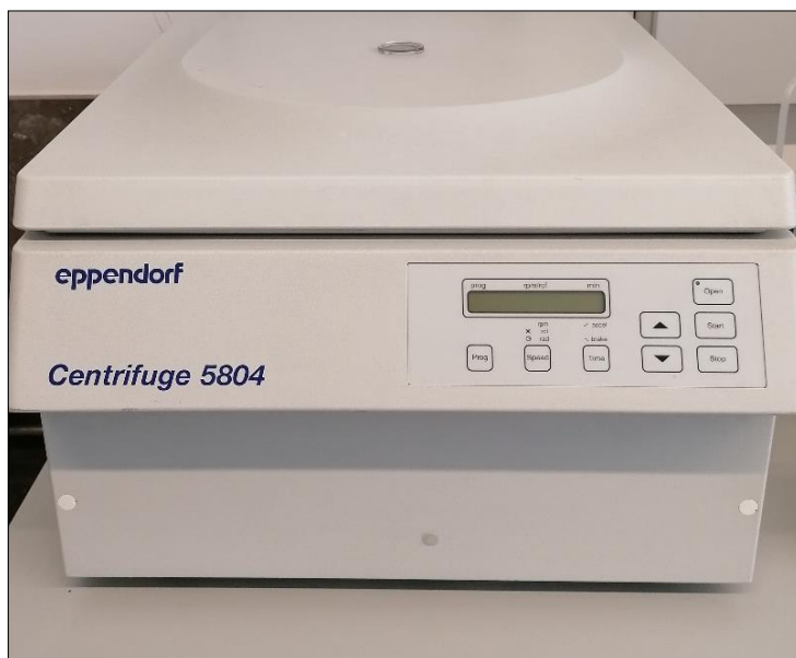
Figura 10 - Centrífuga, Eppendorf AG 5804 (Alemanha).
