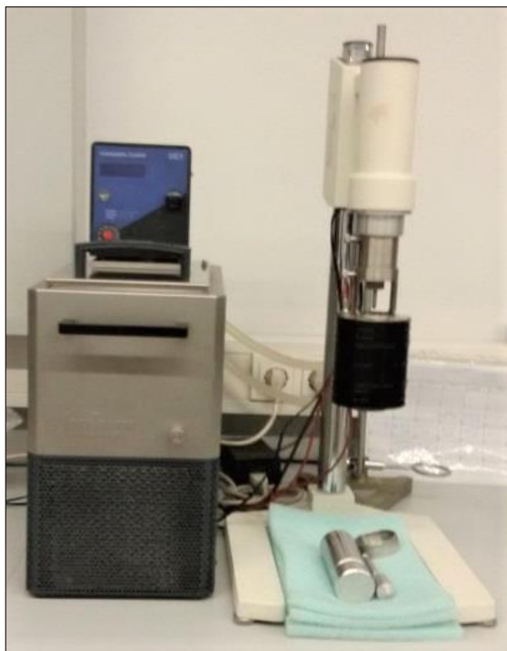
Figura 14 - Viscosímetro, Thermo Haake VT-550 (Alemanha).
