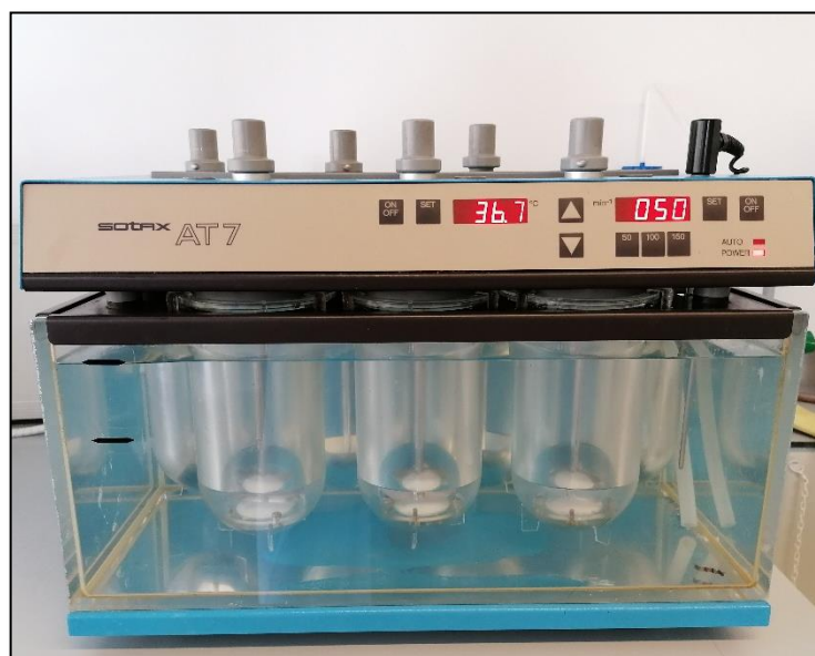
Figura 17 - Aparelho de dissolução, Sotax AT7 (Suíça).
