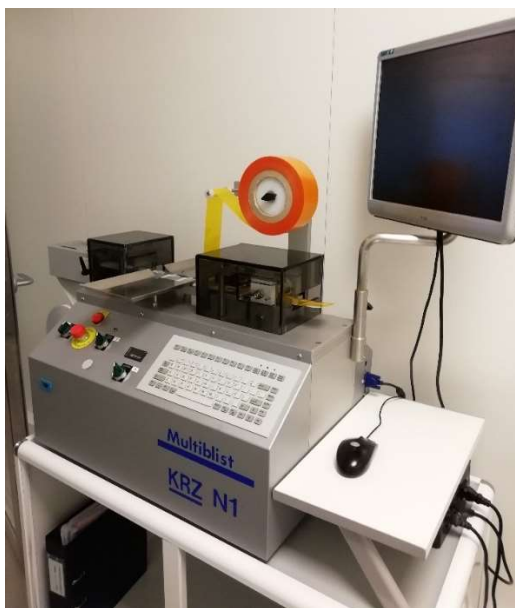
Figura 11 – Equipamento automatizado de reembalagem de formas farmacêuticas orais sólidas.
