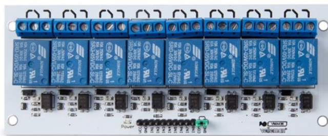
Figura 3.20: Módulo de 8 Relés VELLEMAN VMA436.
