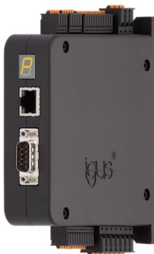
Figura 3.14: Controlador IGUS para os motores passo a passo [14].
