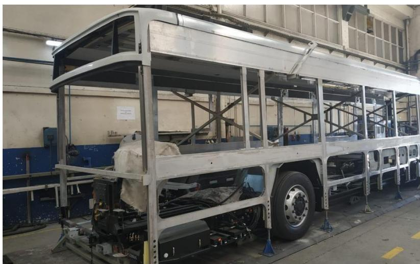
Figura 12- Gaiola de um modelo urbano em fase de acoplação ao chassi
