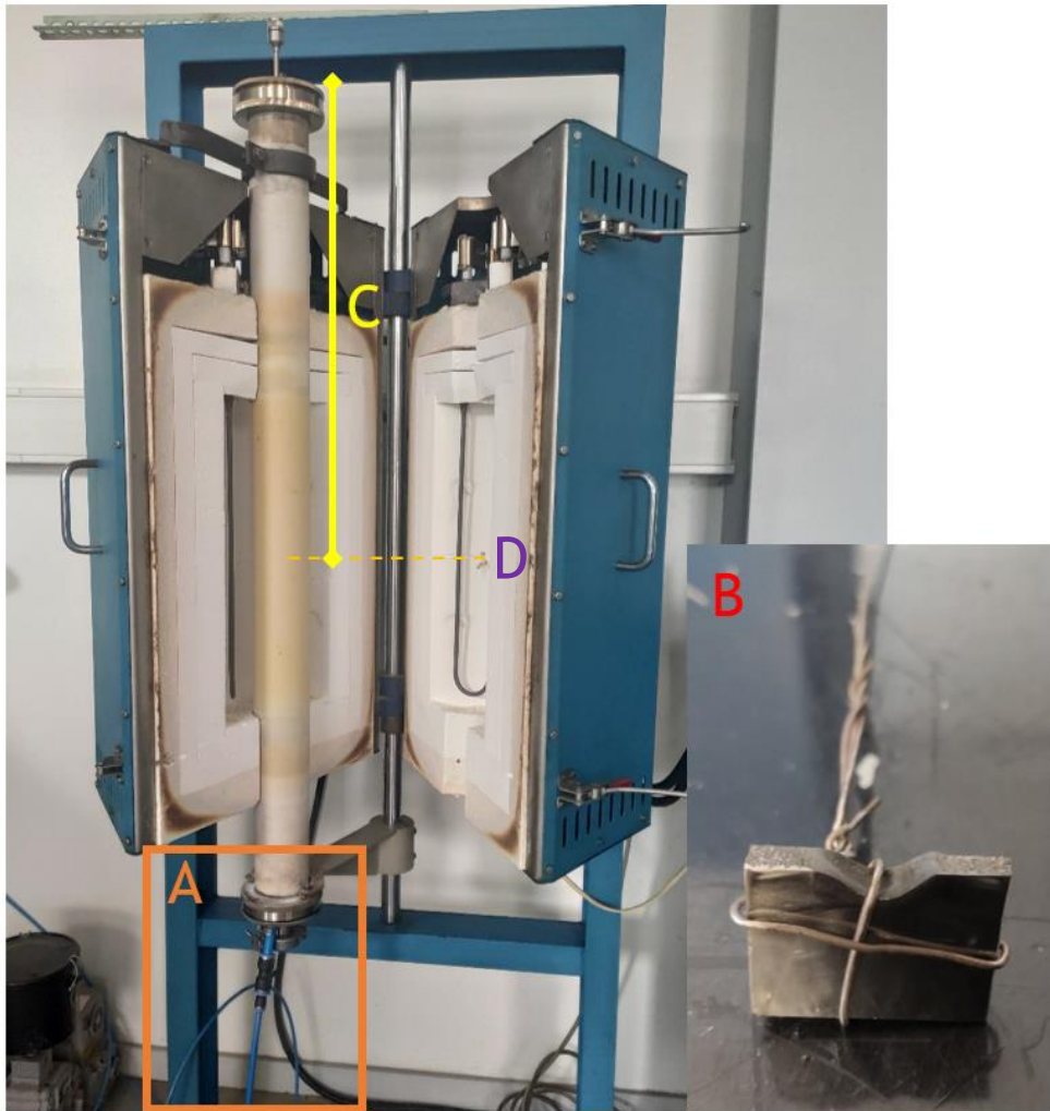
Figura 17: Forno utilizado para os tratamentos térmicos (A: entrada do fluxo de argônio; B: suporte de amostra; C: comprimento do suporte de amostra; D: termopar do forno).
