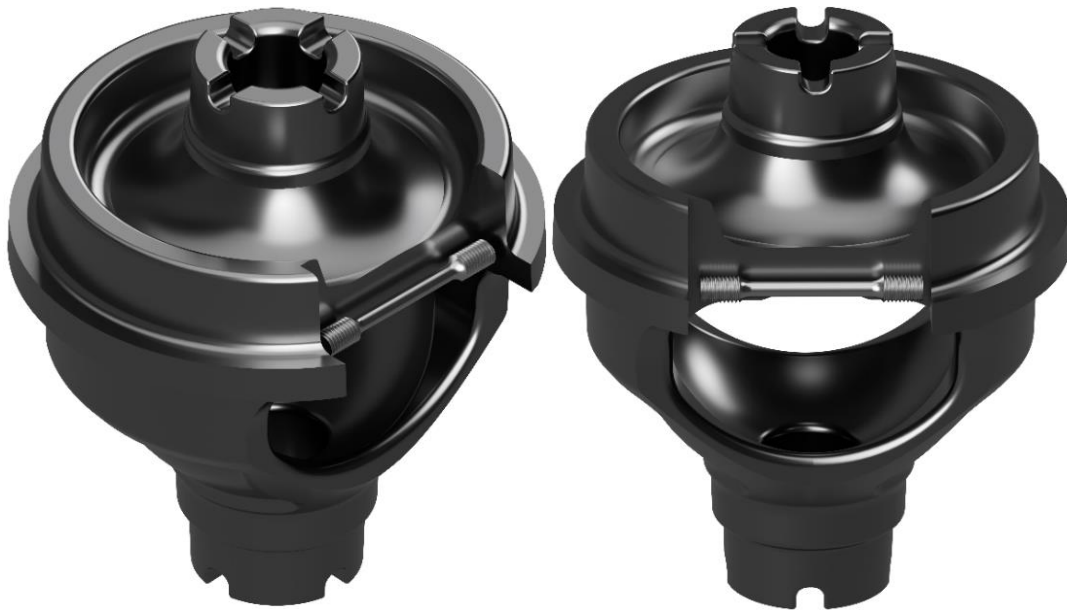
Figura 11 - Secção das peças onde foram maquinados os provetes de tração.
