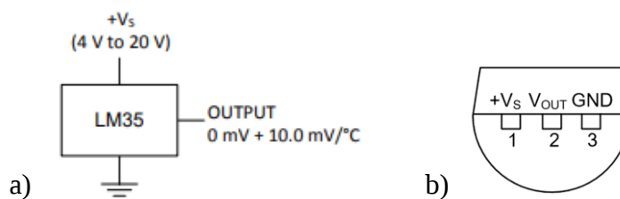
Figura 4.4 – a) Representação esquemática do circuito interno do LM35 b) Configuração dos pinos do LM35 no pacote LP (vista de baixo) [79]
