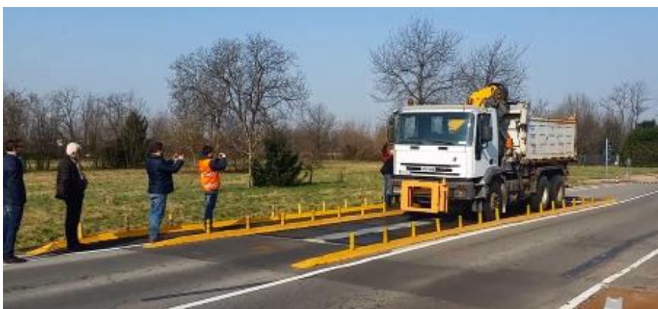
Figura 19 - Teste piloto com a carga máxima por eixo permitida pela normativa italiana, que executa a frenagem de emergência acima da instalação do Lybra - Underground Power
