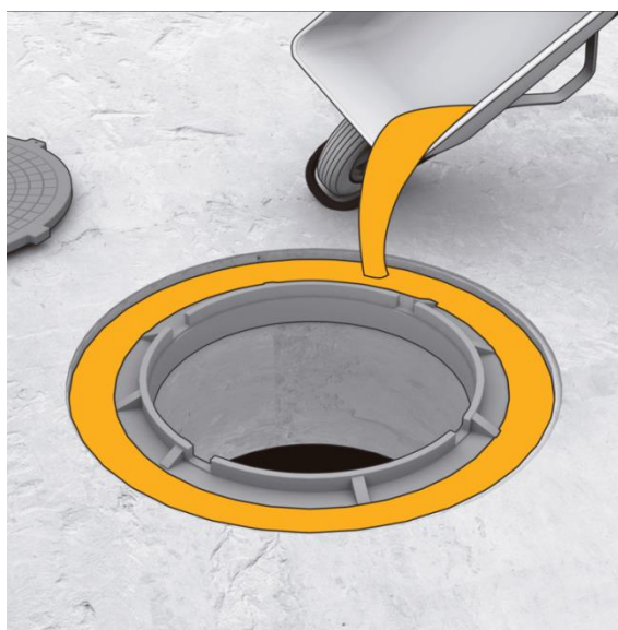
Figura 38 - Demonstração gráfica da argamassa de endurecimento rápido para selagem e fixação em pavimentos rodoviários FastFix-138 TP- Sika
