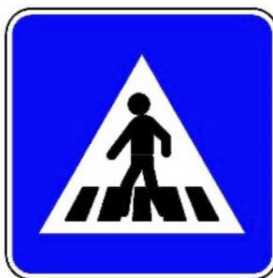
Figura 25 - Sinalização vertical que indica a passagem de pedestres, H7 no Regulamento de Sinalização do Trânsito
