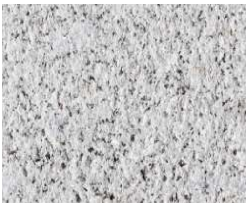
Figura 6.6 – Exemplo de pedra com acabamento bujardado.
