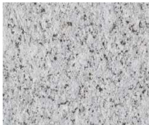
Figura 6.7 – Exemplo de pedra com acabamento a Jato de areia.
