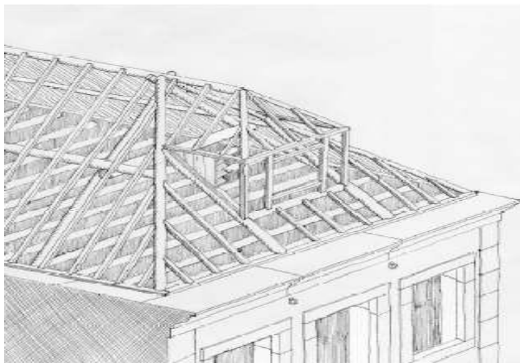
Figura 2.6 – Desenho da estrutura de cobertura de quatro águas com trapeira. Neste exemplo, a estrutura da cobertura é constituída por elementos em forma de paus rolados, a asna é de forma simples com nível e a estrutura da trapeira assenta em duas pernas e numa cadeia. (Retirado [1]).
