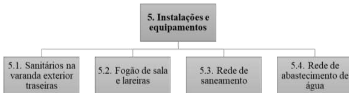
Figura 2.19 – Instalações e equipamentos – decomposição em subsistemas.
