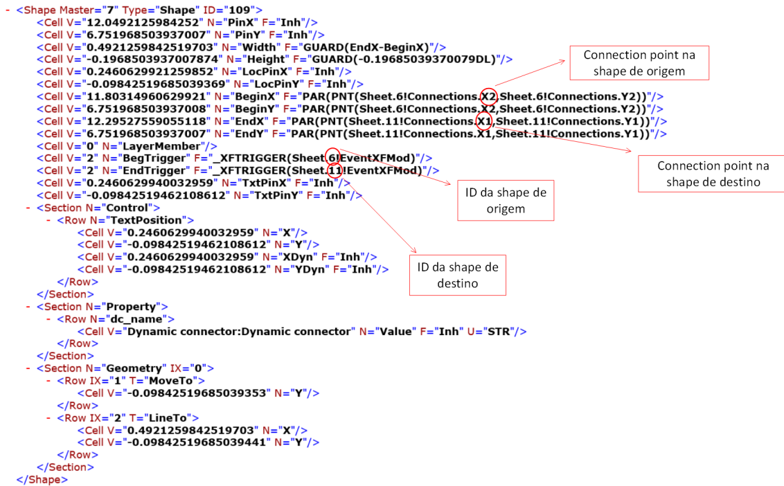
Figura 4.23: Informação associada a um Dynamic connector , representada no ficheiro XML
