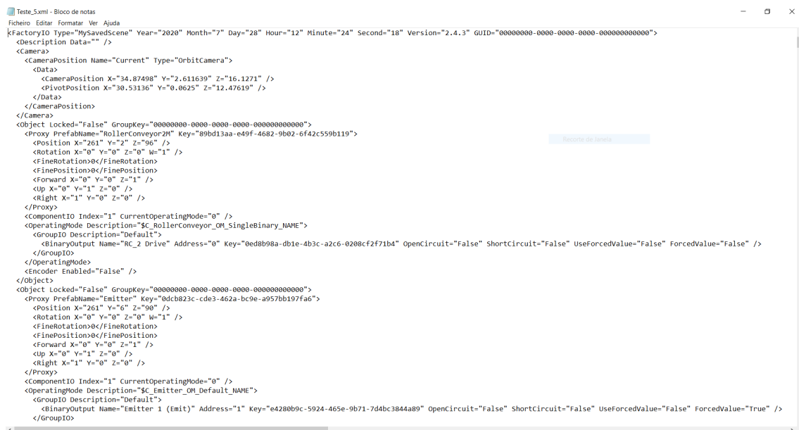
Figura 5.2: Estrutura XML de um cenário de Factory IO vista no Bloco de notas
