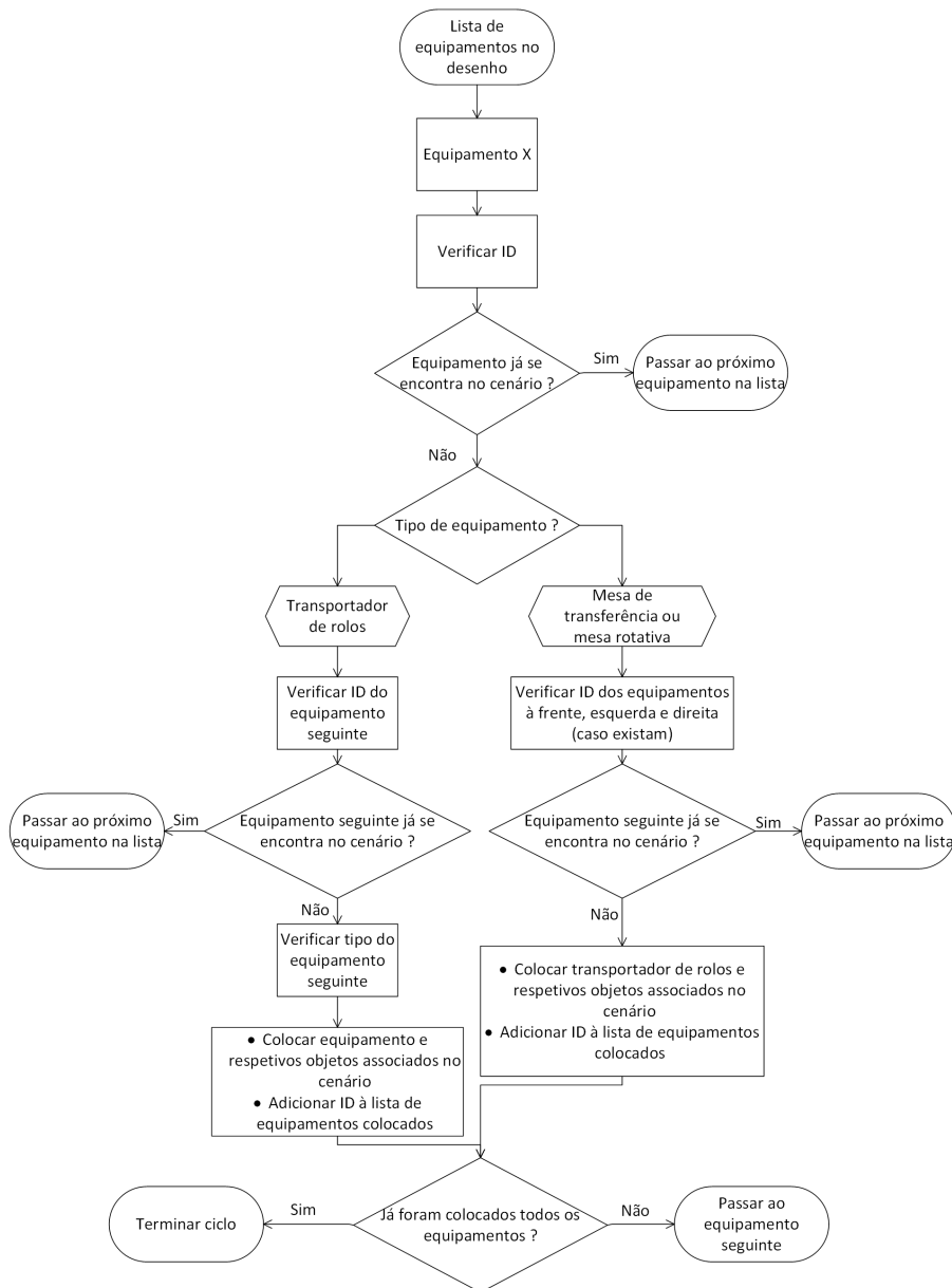
Figura 5.7: Lógica da colocação de equipamentos no ambiente virtual
