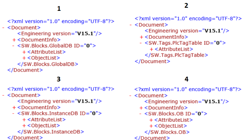
Figura 4.30: Exemplo dos elementos principais e o CodeBlock de cada tipo de ficheiro. 1) Global DB ; 2) Tag Table ; 3) Instance DB ; 4) OB
