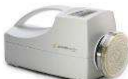
Figura 7 - Equipamento de medição ambiental por Filtração (AirPort Sartorius) 19
