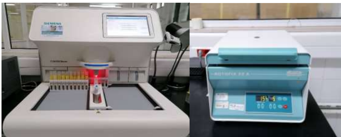
Figura 30 Equipamento destinado à realização da análise sumária da urina, CLINITEK Novus (à esquerda) e centrífuga destinada à obtenção do sedimento urinário (direita). (Fotografias obtidas a partir do sistema utilizado no Serviço de Patologia Clínica do HFAR-PP)
