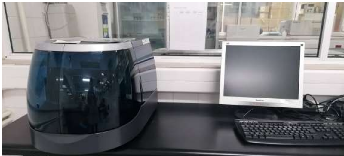
Figura 28. Equipamento destinado à realização de eletroforeses, Minicap da Sebia, presente no setor de Química Clínica. (Fotografia obtida no Serviço de Patologia Clínica do HFAR-PP)
