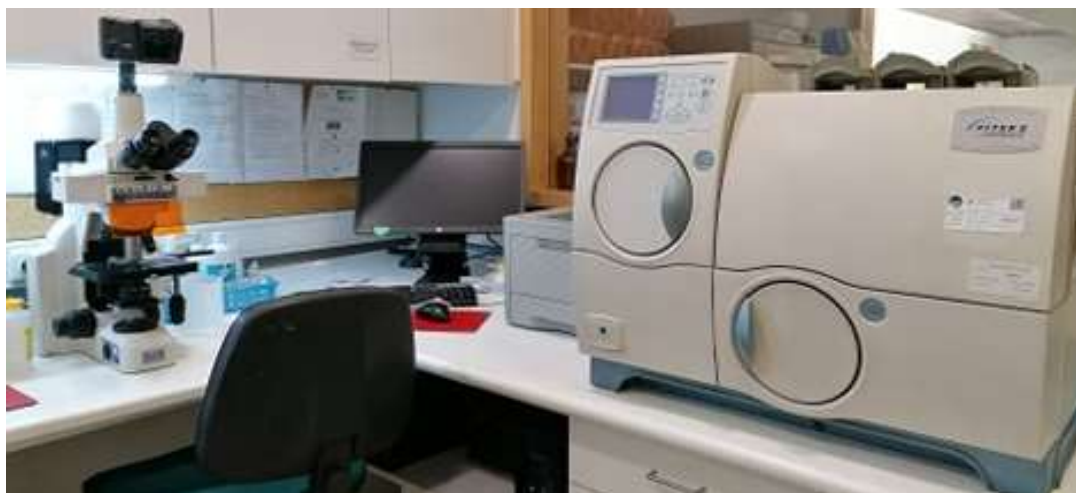
Figura 34. Equipamento VITEK® 2 Compact presente no setor de microbiologia do Laboratório de Análises Clínicas S. Lázaro. (Fotografia obtida no Serviço de Microbiologia do LACSL)
