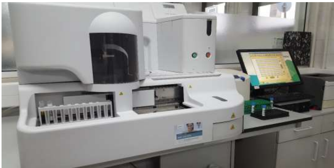
Figura 12. Analisador Automático Sysmex CS-2100i no Laboratório de Patologia Clínica do HFAR-PP. (Fotografia obtida no Serviço de Patologia Clínica do HFAR-PP)
