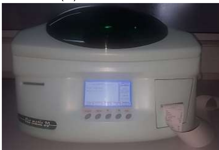
Figura 10. Analisador de bancada, VES-MATIC 30, presente no laboratório de Patologia Clínica (Fotografia obtida no Serviço de Patologia Clínica do HFAR-PP).
