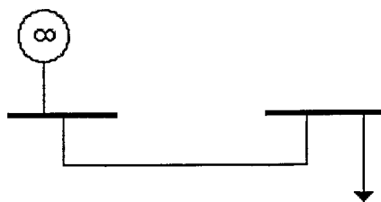
Figura 2.2 - Sistema com uma única carga alimentada por um barramento de potência infinita
