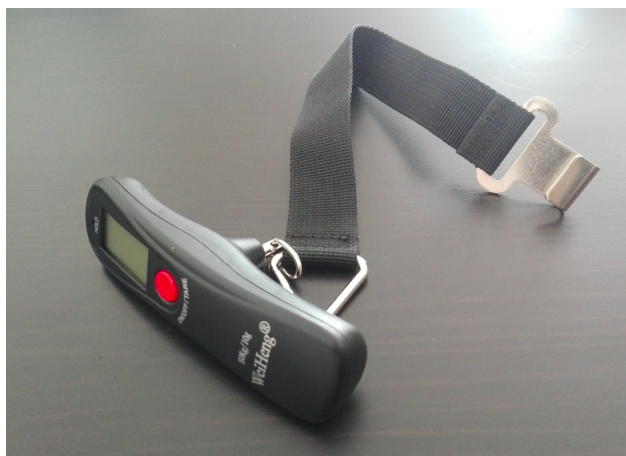
Figura 16: Balança vertical utilizada na medição e cálculo das forças a exercer nos diversos manípulos do motocultivador.
