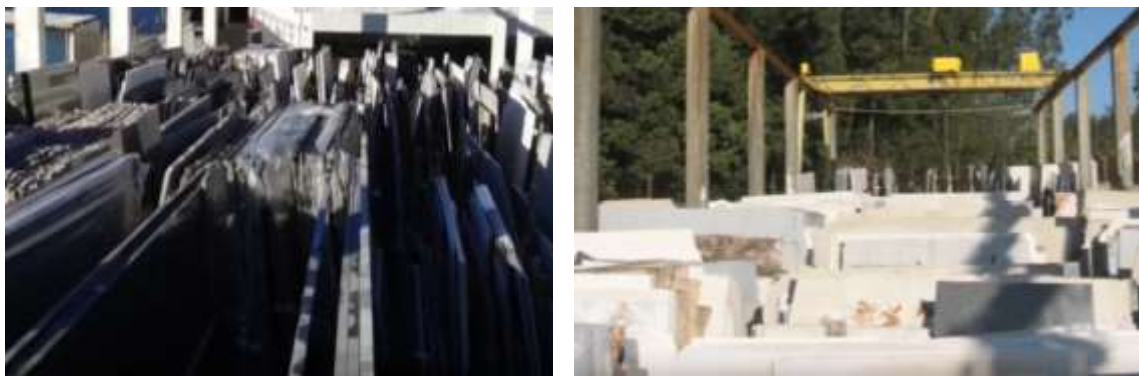
Figura 68 – Fotogramas de vídeo sobre a organização de chapas no parque de matérias primas da TORRE, com um layout de difícil acesso às peças estacionadas. (Marques, 2016 d)).
