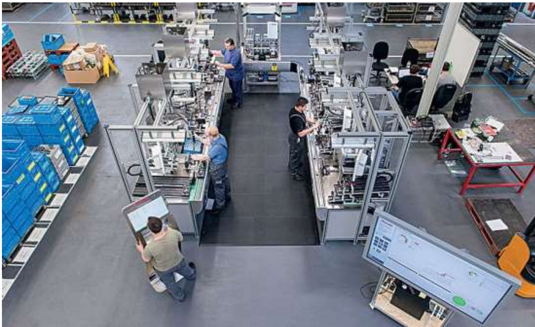
Figura 9 – Exemplo de uma célula de produção em U. Imagem da Internet. Acedido em maio de 2020 em:
