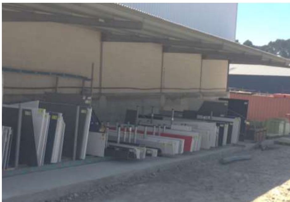
Figura 82 - Armazenamento de chapas de Silestone por tamanhos na TORRE (fotografia de Filipe Marques de setembro de 2020).
