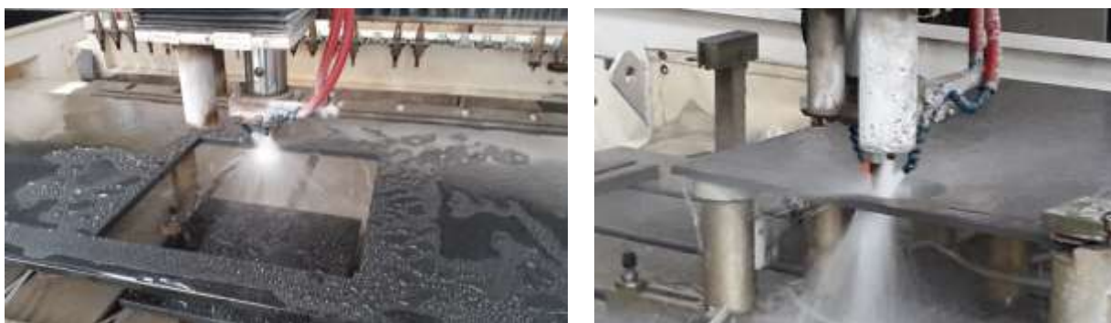
Figura 38 – Máquinas CNC's, de corte com jato de água a alta pressão na TORRE.
