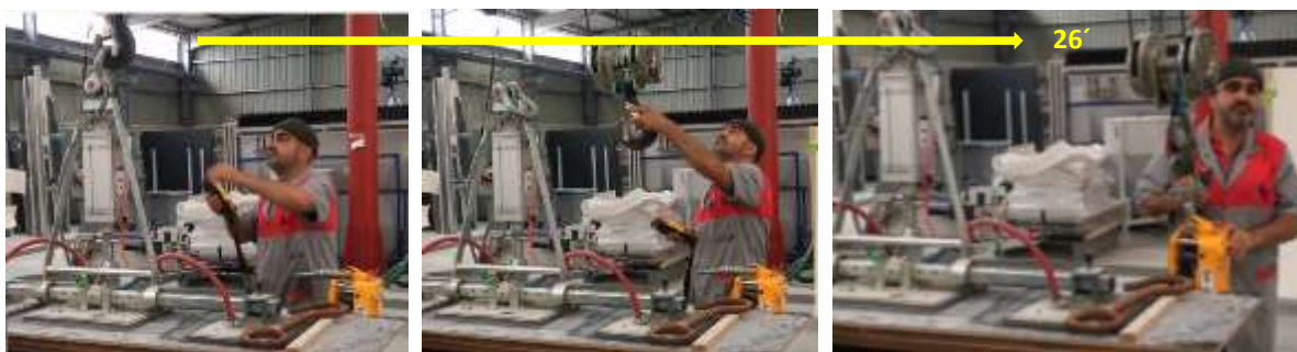
Figura 56 – Fotogramas de vídeo de um processo moroso de troca de ferramentas num sistema de elevação na TORRE (Marques, 2016 b)).
