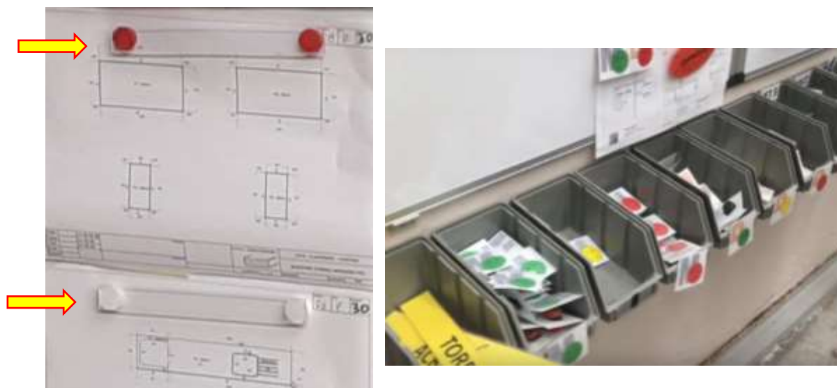
Figura 59 – Exemplos de suportes magnéticos coloridos, com diferentes significados, para acompanhamento dos processos produtivos na TORRE. Por exemplo, as obras a realizar assinaladas com imanes vermelhos, são prioritárias relativamente às assinaladas a branco.
