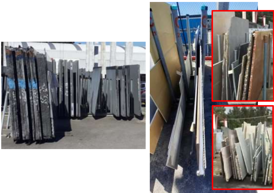
Figura 81 - Alguns pormenores da arrumação de chapas no parque de matérias primas da TORRE. À esquerda, chapas originais e à direita sobras de chapas.
