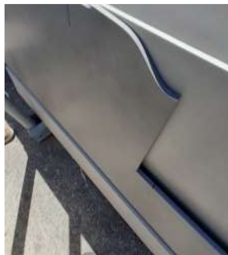
Figura 78 - Exemplos de defeitos de processamento: à esquerda um pré-corte e à direita um corte em forma de “pistola”.
