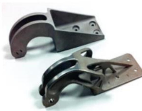
Figura 9- Processo tradicional versus Processo fabrico aditivo [12].
