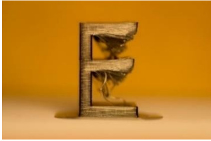
Figura 7 - Peça sem suportes estruturais.
