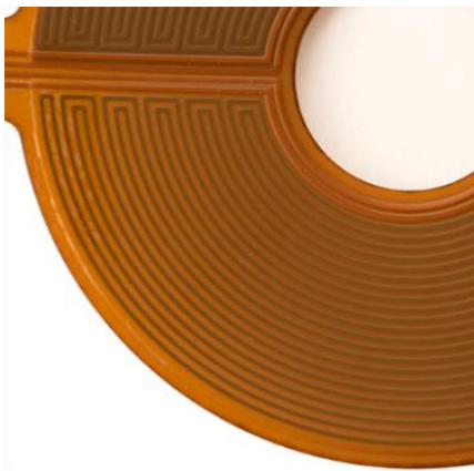
Figura 46 - Aquecedor de Poli-imida [48].
