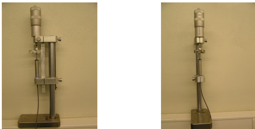
Figura 3.29: Calibração dos transdutores de deslocamento (LVDT's) com uso do micrómetro
