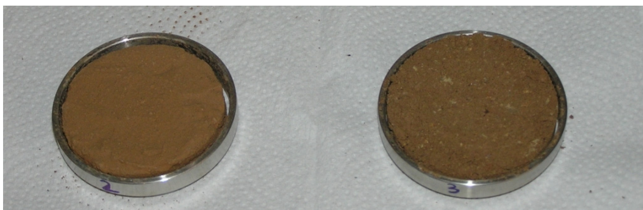
Figura 3.57: Provetes ensaiados da amostra EN-MG, com clara diminuição de volume (retracção)
