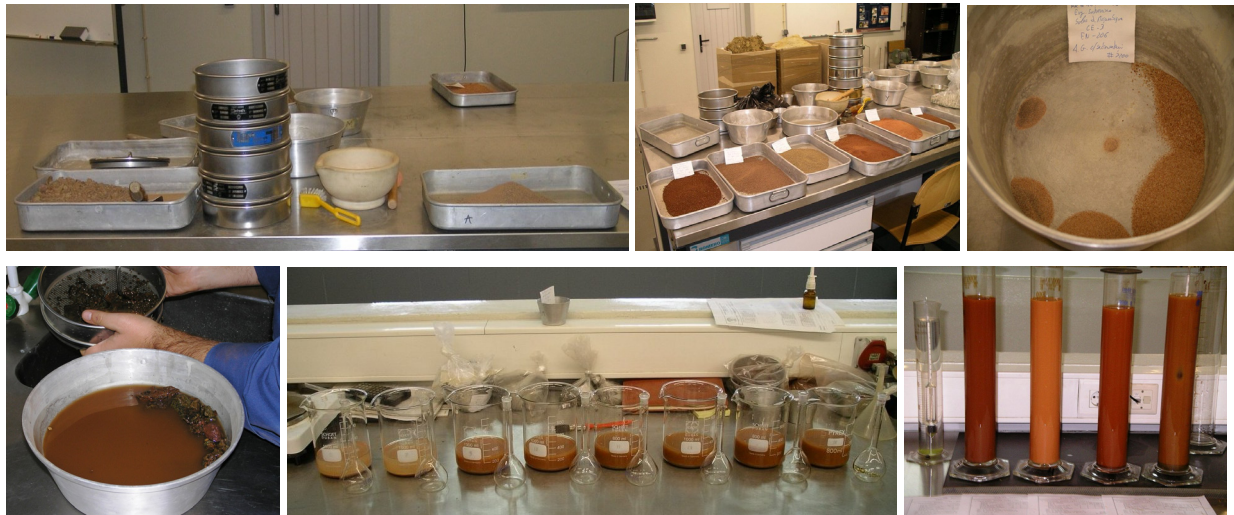
Figura 3.1: Algumas das fases dos ensaios de identificação
