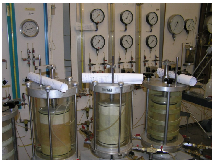
Figura 3.45: a) Provetes em câmaras triaxiais durante a molhagem b) Proвете em fase de secagem
