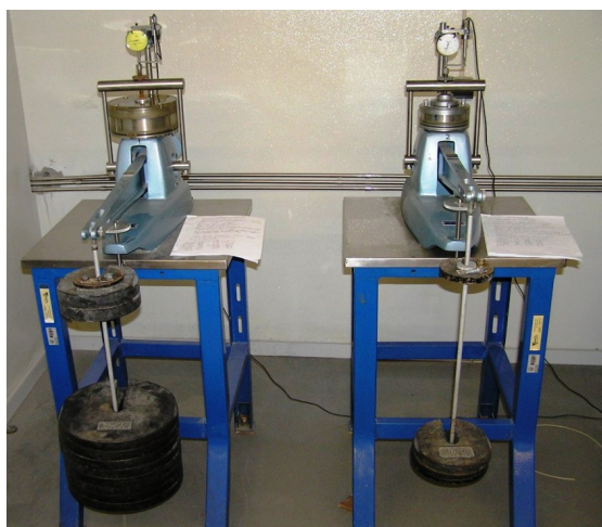
Figura 3.24: a) Ensaios edométricos em curso para as duas amostras de solos estudadas
