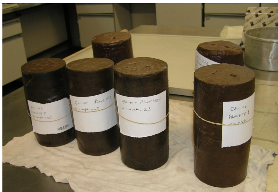
a) Provetes parafinados para verificação da saturação
