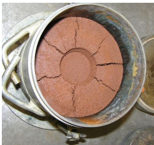
Figura 3.19: Dois provetes ensaiados no molde CBR para a estrada EN-206 podendo-se ver as fissuras no solo
