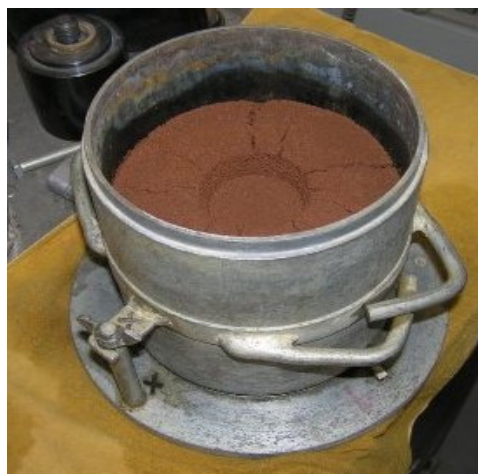
Figura 3.19: Dois provetes ensaiados no molde CBR para a estrada EN-206 podendo-se ver as fissuras no solo
