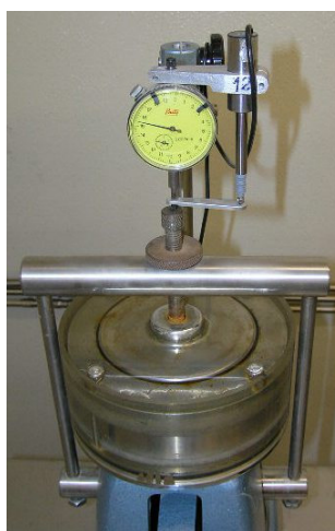
b) Anéis de 125mm e de 75mm instrumentados com deflectómetros e transdutores de deslocamento vertical
