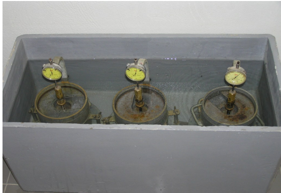
Figura 3.14: Provetes imersos em água antes da penetração
