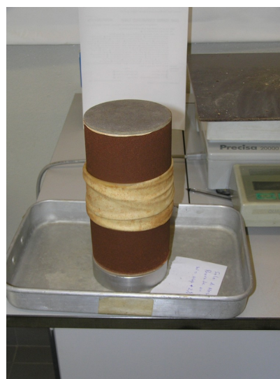
Figura 3.45: a) Provetes em câmaras triaxiais durante a molhagem b) Proвете em fase de secagem
