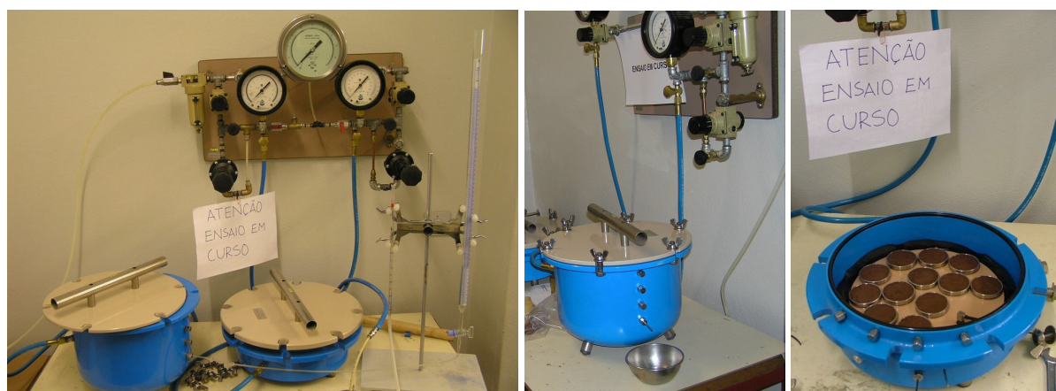
Figura 3.49: Esquema de montagem dos equipamentos e colocação dos provetes na panela
