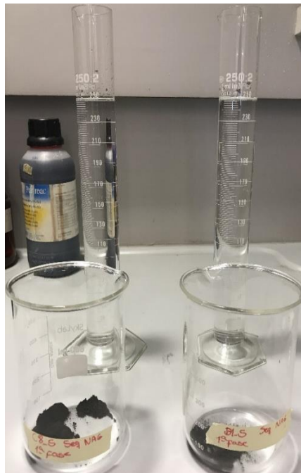
Figura 55. Amostras de rejeitado a serem ensaiadas em NAG sequencial.
