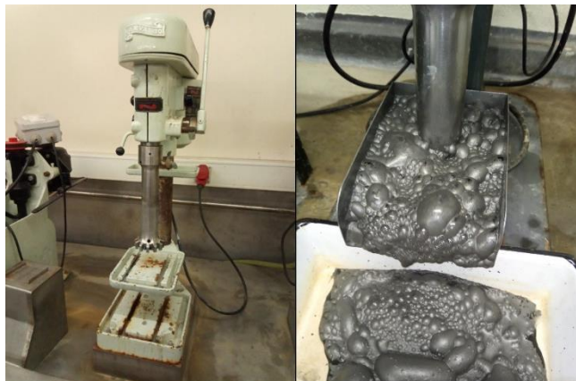
Figura 104. Célula Denver e ensaio de flutuação inversa.
