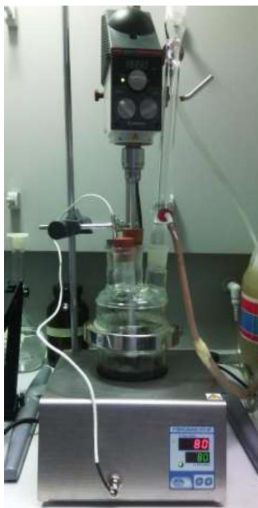
Figura 91. Montagem para o ensaio de lixiviação com o reator de mistura ideal em regime de agitação contínua (Matos, 2017).
