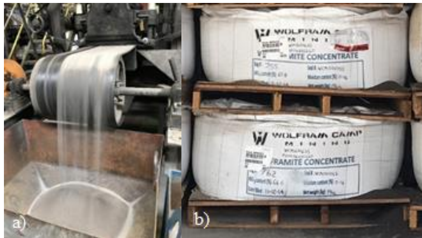
Figura 25. a) Concentração por separação magnética e b) armazenamento de concentrado de wolframite (Da autora, 2017).
