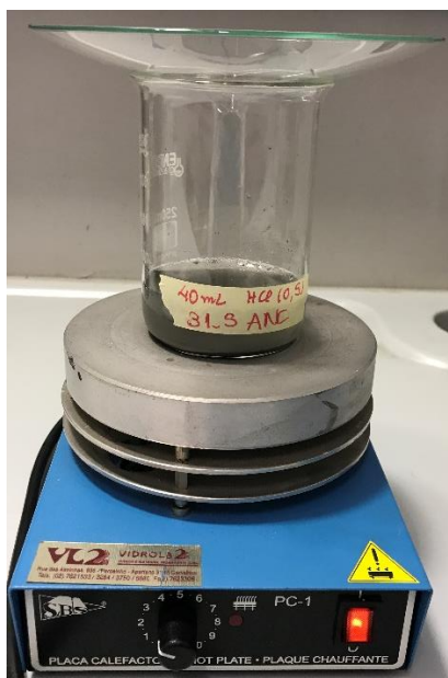
Figura 54. Aquecimento da mistura pelo método Sobek modificado.
