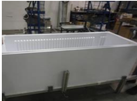
Figura 15. Cuba encaixada no exterior do armário [7].
