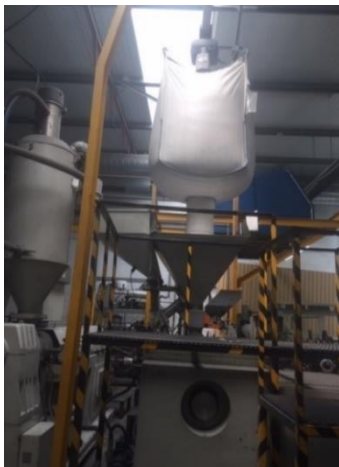
Figura 8. Funil de alimentação da máquina extrusora de plástico.
