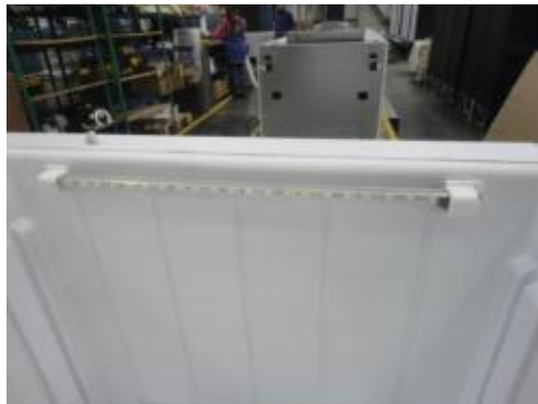
Figura 19. Iluminação LED no teto do frigorífico [7].
