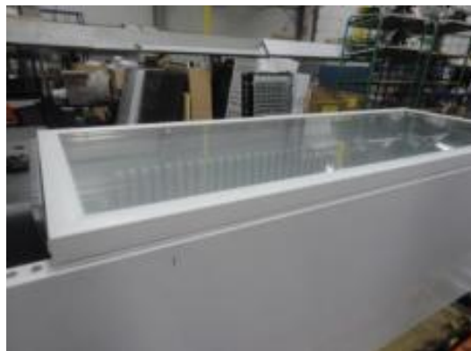
Figura 21. Colocação da porta de vidro ao armário [7].
