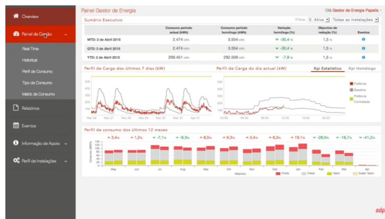
Figura 2: Painel Gestor de Energia, Gestão de Consumos – EDP 8 (EDP Comercial, 2015)
