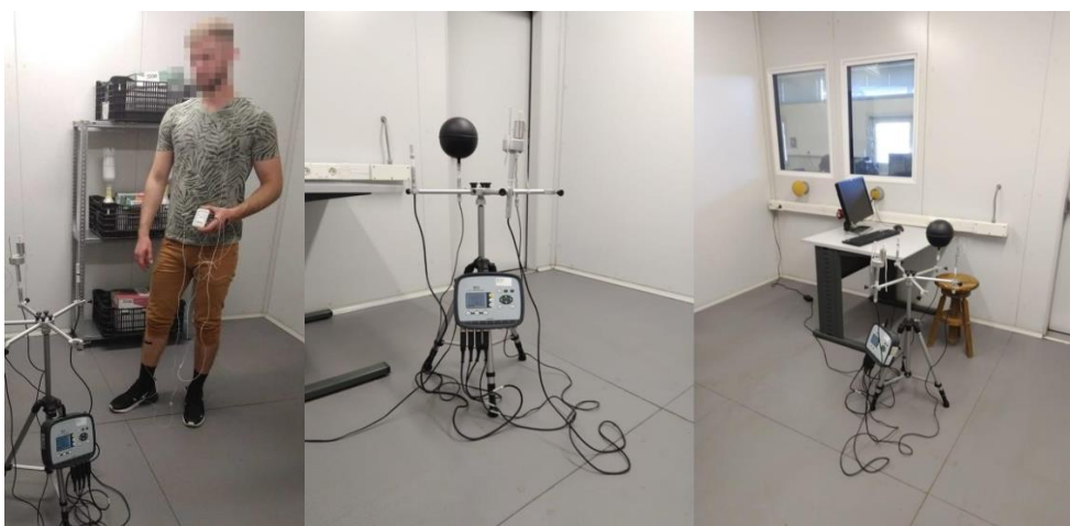
Figura 9.1 Medição em câmara climática, laboratório do PROA
