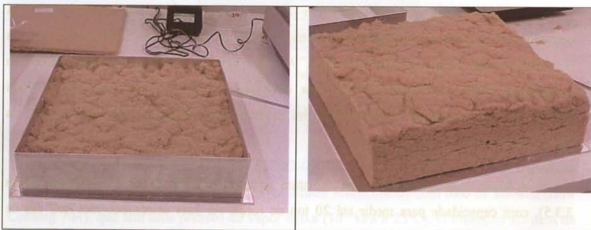
Figura 3.4.1 – Aspecto de um colchão de MDF em formação e antes da prensagem em laboratório.
