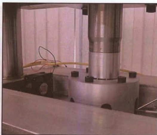
Figura 3.3.2 – Visualização da zona de inserção da célula de carga na haste do cilindro.
