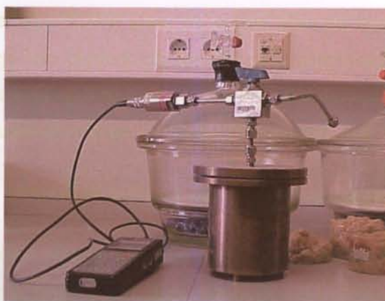
Figura 3.4.3 – Instalação para secagem sob vácuo das amostras de MDF.
