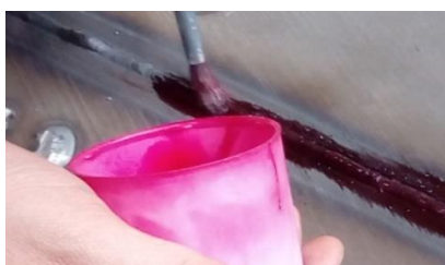
Figura 17 - Aplicação do líquido penetrante
