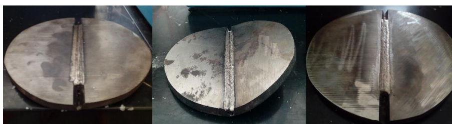
Figura 26 - Provetes soldados, da direita para a esquerda: com pré-aquecimento, controlo, com temper bead
