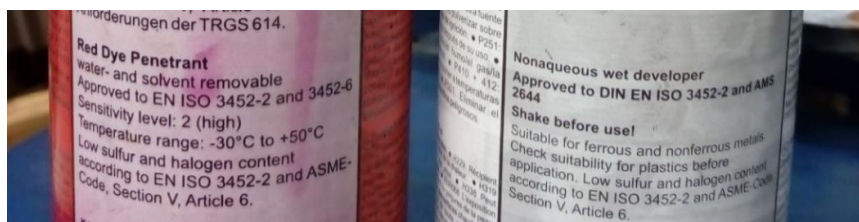
Figura 16 - Líquidos penetrante e revelador utilizados no ensaio de líquidos penetrantes
