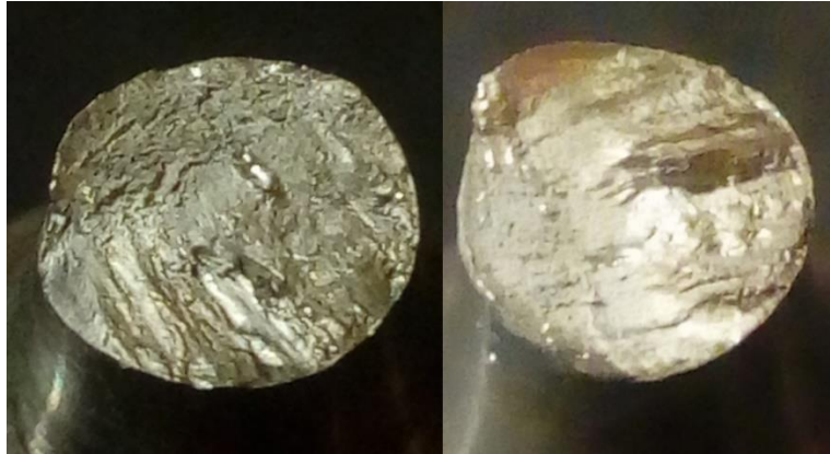
Figura 46 - Faces de fratura por fadiga dos provetes com pré-aquecimento (esquerda) e com temper bead (direita)
