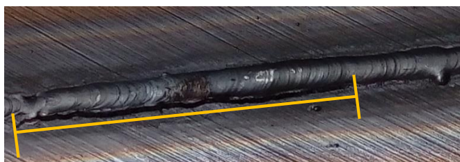
Figura 27 - Fissura de ~5 cm no provete de controlo
