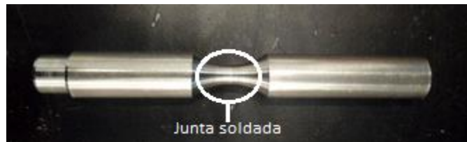
Figura 21 - Provede em ampolheta de carregamento em ponto único
