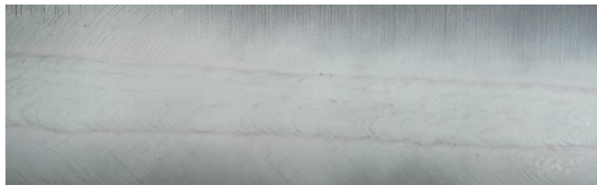
Figura 31 - Junta soldada do lado superior do provete com temperbead
