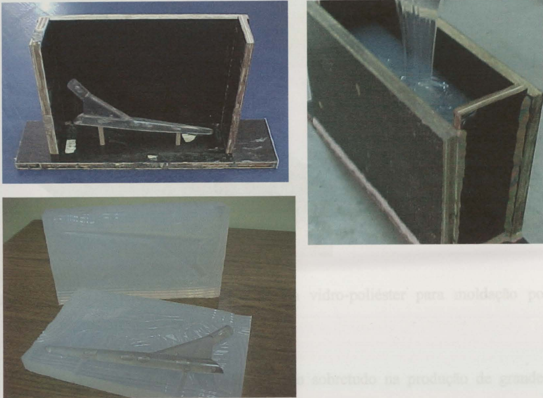
Figura 4.19 – Fases de produção de um molde em silicone
