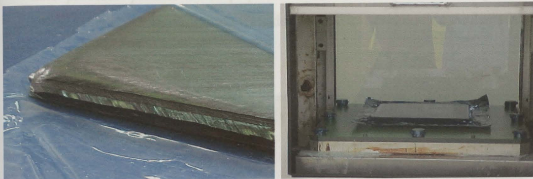
Figura 4.17 – Produção de um laminado carbono-epóxico numa prensa de pratos quentes
