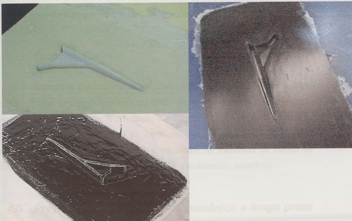
Figura 4.20 – Produção de um molde em vidro-poliéster para moldação por transferência de resina (RTM)
