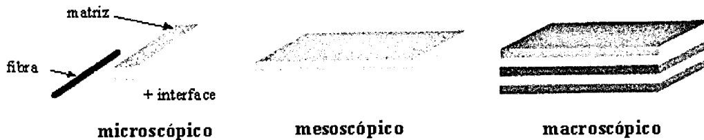
Figura 4.21 - Diferentes escalas de observação na identificação de modelo de comportamento mecânico de materiais compósitos
