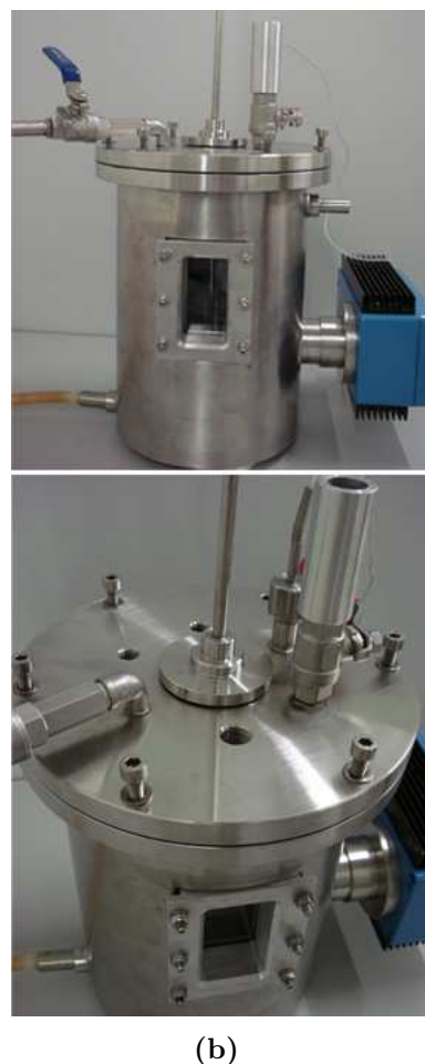
Figura 4.3: Projecto do cristalizador (dimensões em mm) : A - agitador; R - refractómetro; s - vaso das sementes; v - válvula para conexão da bomba de vácuo (a). Fotografias do cristalizador (b).
