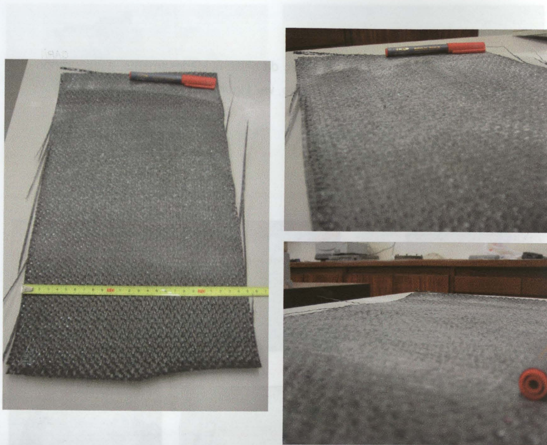
Figura 3. 21 – Inspeção visual do geossintético danificado.
