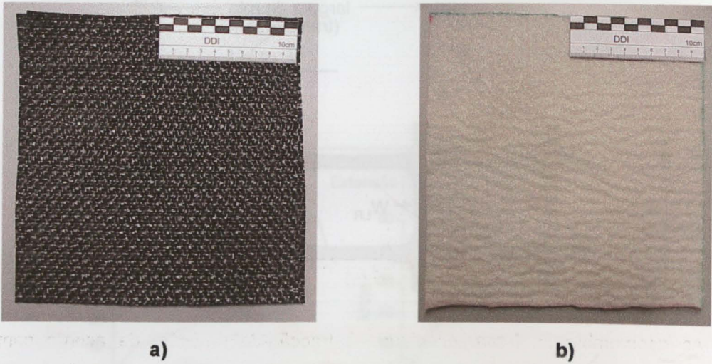
Figura 4. 6 – Geotêxteis: a) tecido (GTt); b) não tecido agulhado (GTnt).
