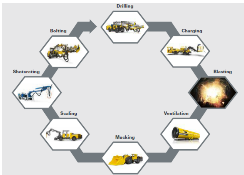
Figura 11 - Sequência de trabalhos realizados na escavação de um túnel, pelo método de perfuração e detonação (Atlas Copco, 2014).
