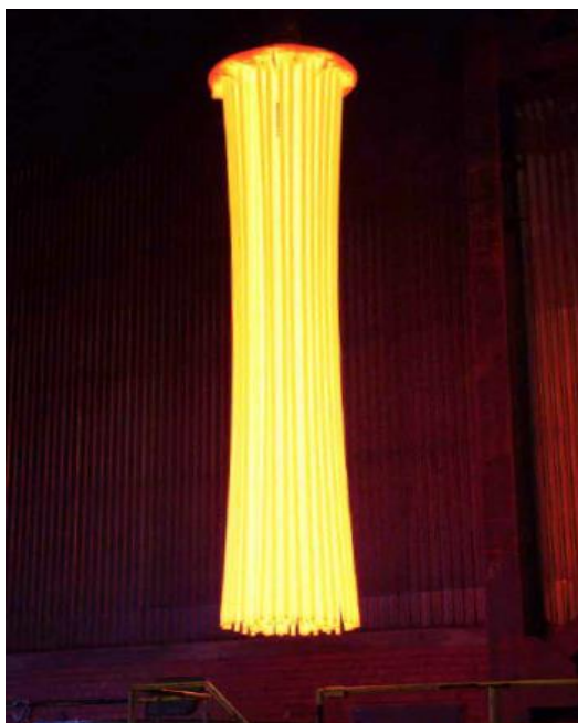
Figura 59 -Conjunto de varas à saída do processo de carburização (Sandvik, 2013).
