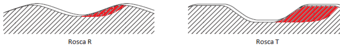
Figura 58 – Áreas de desgaste das roscas R e T (adaptado de Mitsubishi, 2014).
