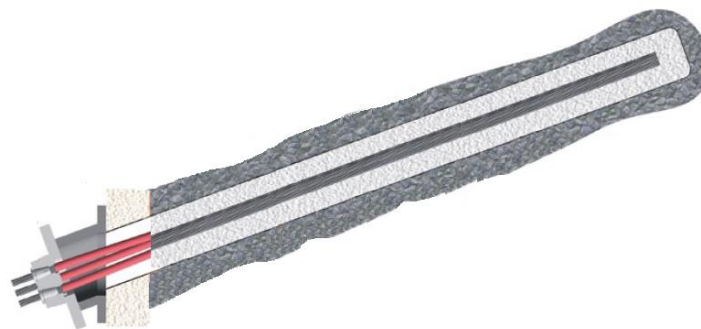
Figura 77 – Esquema de uma ancoragem por cabo típica dos projetos estudados
