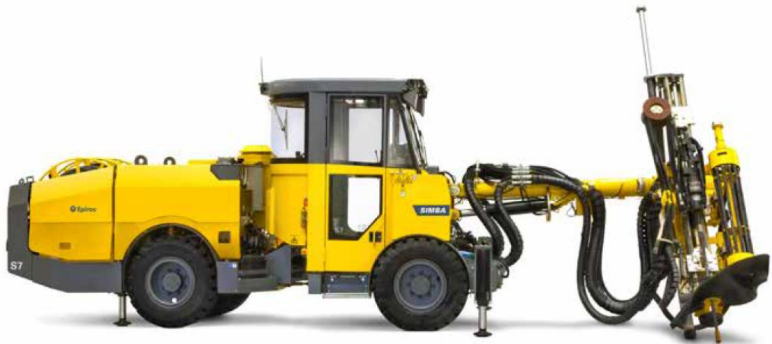
Figura 81 – Exemplo de um Jumbo de furação Atlas Copco Simba S7 (ver anexo 14 – Especificações Simba S7).
