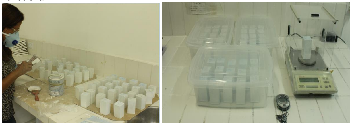
Figura 2 - Pintura, imersão e pesagem dos provetes no ensaio de capilaridade.
