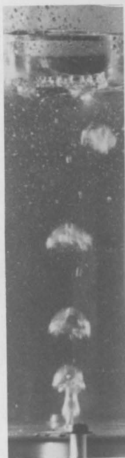
Figura 3.2 - Borbulhamento de ar em água, através de um orifício de 3,0 mm, à pressão atmosférica
