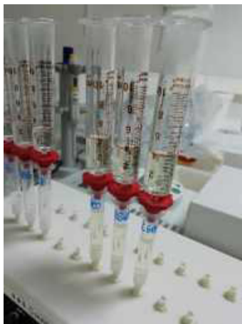
Figura 13 - Processo de purificação com o uso da coluna de imunoafinidade
