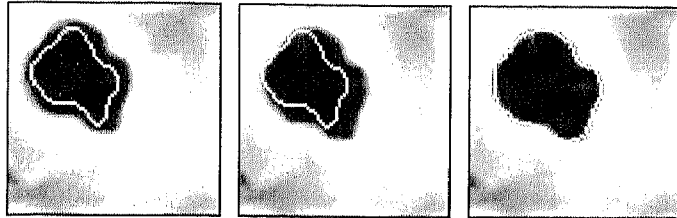
Figura 73: Utilização da contracção do contorno obtido na imagem inicial (esquerda) como contorno inicial da segunda imagem(centro) e resultados obtidos (direita).
