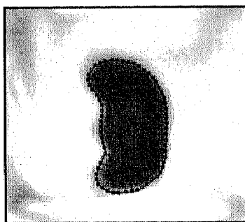
Figura 59: Operação de contracção do contorno obtido.
