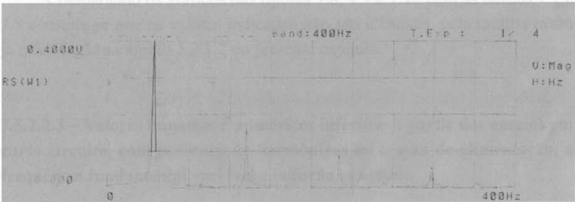
Figura 7.8 : Exemplo de um espectro de frequências da tensão de alimentação em curto circuito, a frequência fundamental 45Hz
