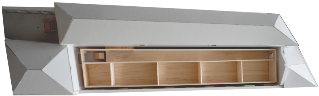
Fig.132 Maqueta de trabalho. Novo corpo inserido no existente (armazém F)
