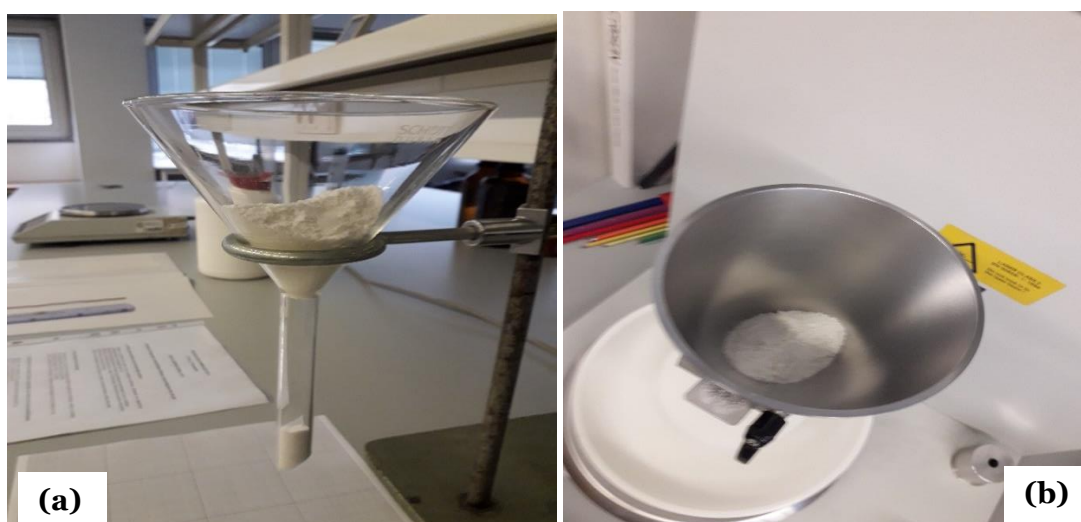
Figura 14: Funil (a) e método automático (b) do ensaio de escoamento
