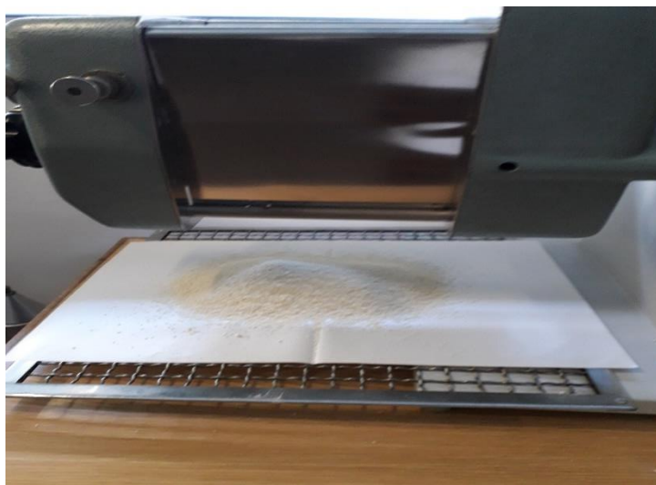
Figura 15: Granulação (granulador Erweka FGS)
