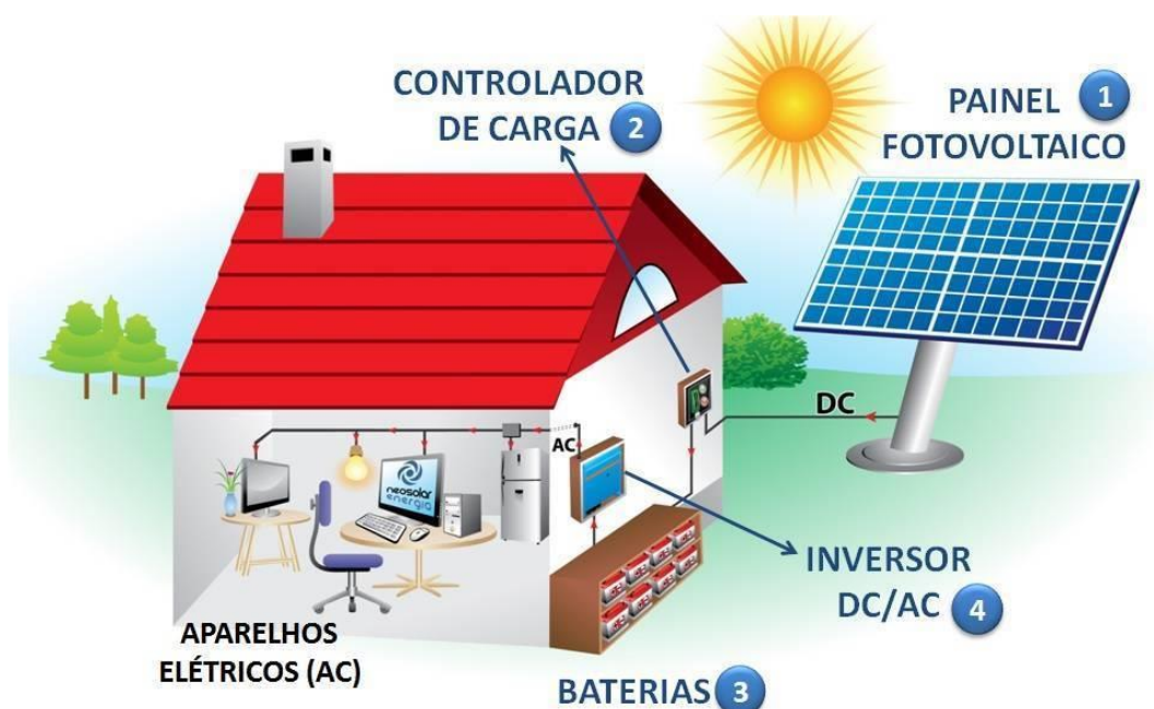
Figura 11. Funcionamento de um sistema solar fotovoltaico.
