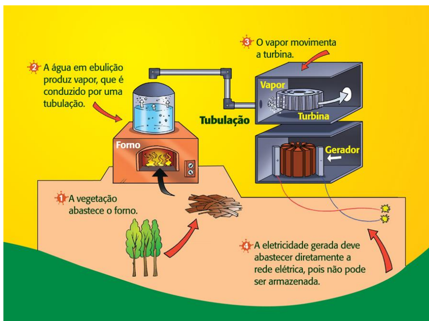
Figura 12. Conceito do funcionamento de um sistema de biomassa.
